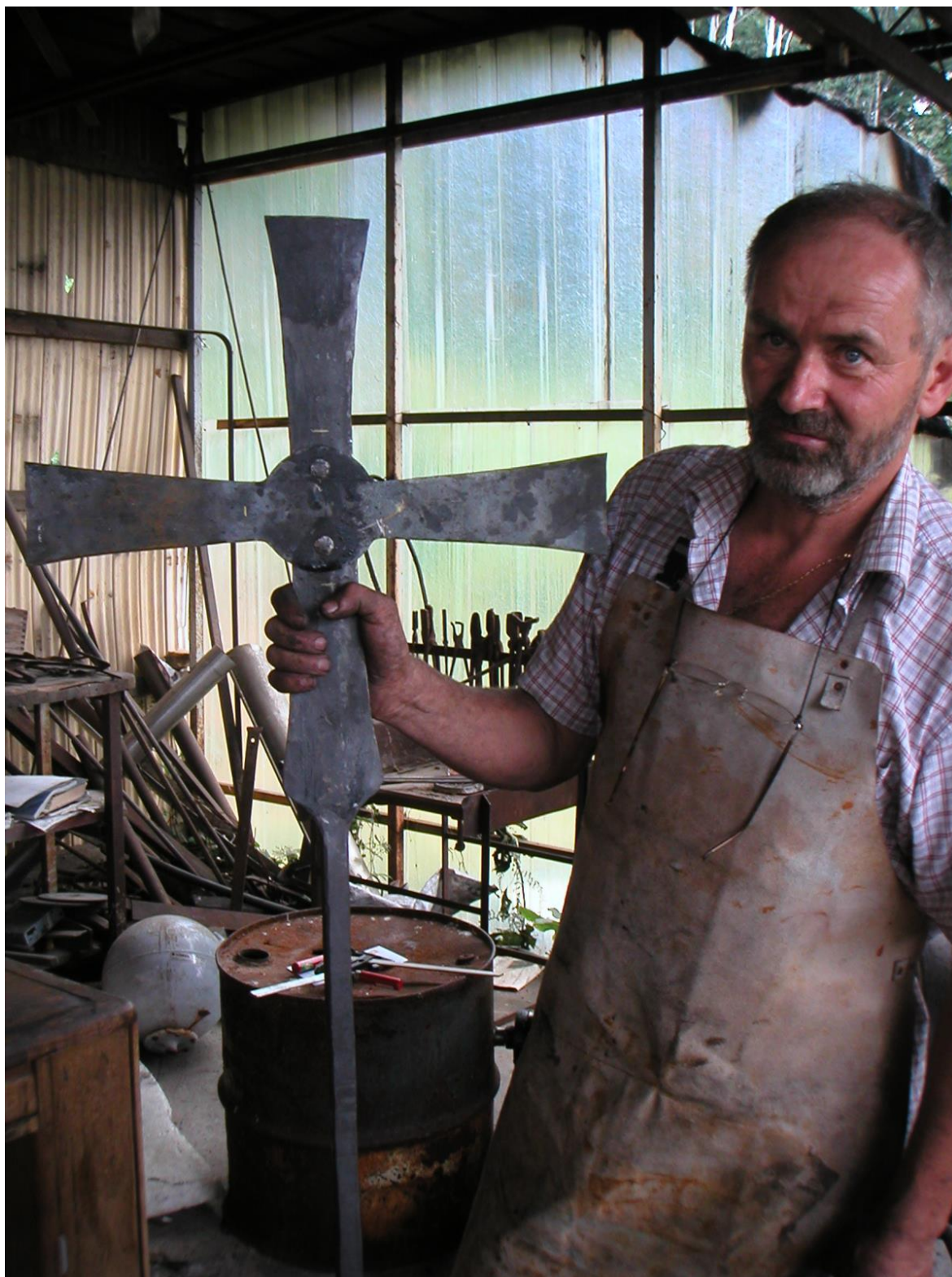
Il signor Aldo Conto, fabbro di Alice Superiore, con una delle due copie della croce del campanile nord, eseguite con tecnica tradizionale di forgiatura, rimesse in opera su entrambi i campanili.
