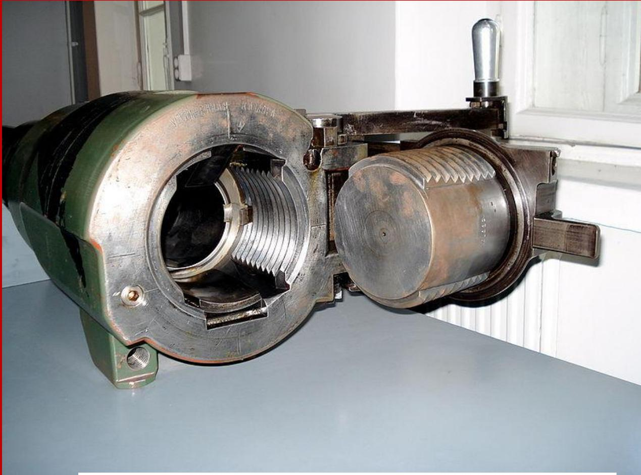
Otturatore a vite interrotta di obice russo
