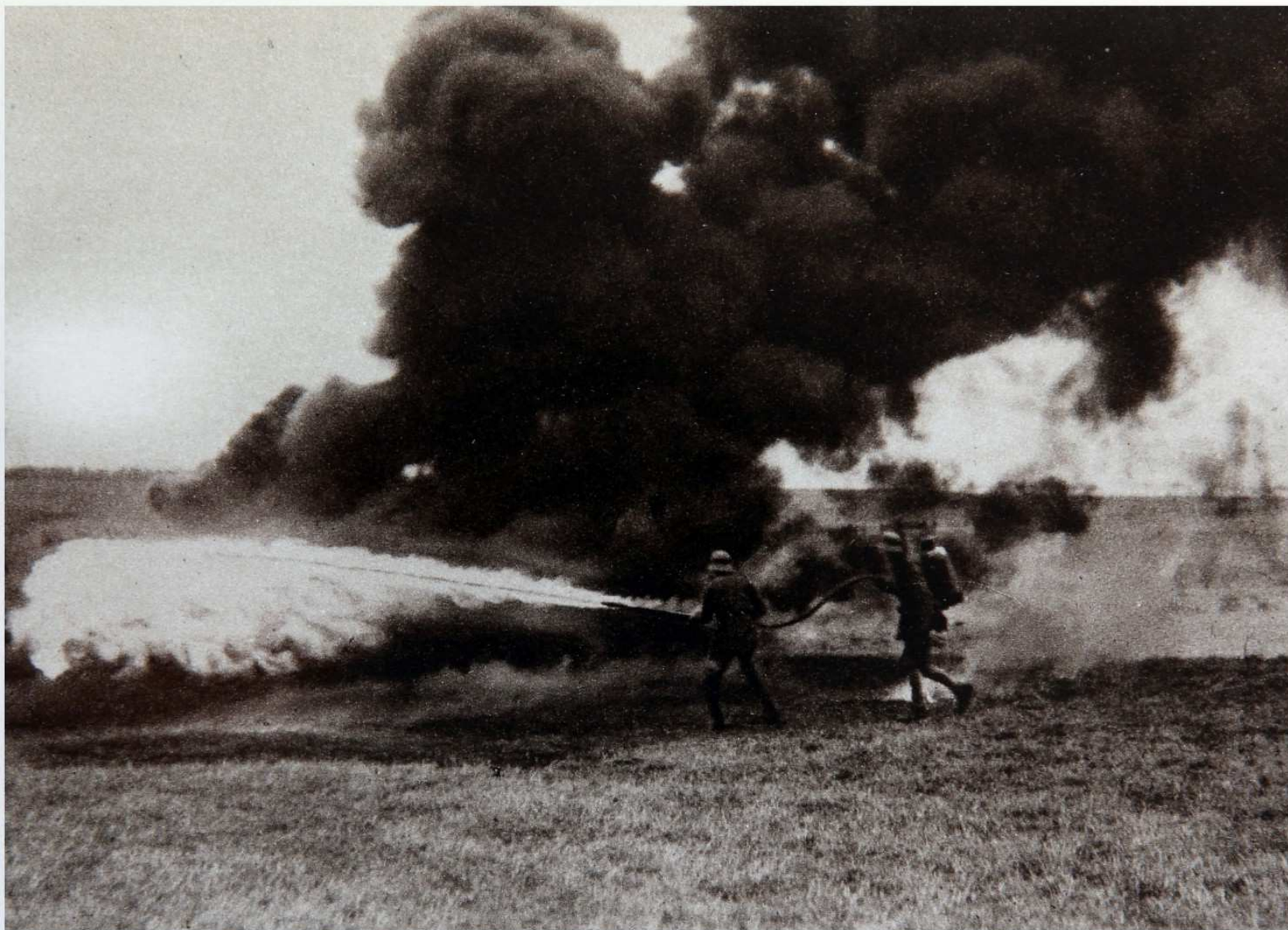
Zu den modernsten Nahkampfmitteln gehörte der „Flammenwerfer“, der insbesondere gegen Unterstände, Maschinengewehrneister und Tanks Verwendung fand. Es handelt sich um einen tragbaren zylindrischen Behälter mit langem Schlauchmundstück, aus dem mittels Preßluft brennendes Öl in einer riesigen Stichflamme geschleudert wurde. Die Entzündung erfolgte beim Ausströmen auf chemischem Wege. Die dabei entwickelte Hitze war derart, daß die Getroffenen sofort zu Kohle verbrannten. Hinter der starken Rauchwolke konnten sich die Sturmtruppen leicht entwickeln.
