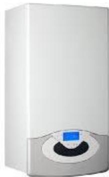
Una caldaia a condensazione è una caldaia ad acqua calda nella quale si ha la condensazione del vapore acqueo dei fumi di scarico. In questo modo si ha il recupero del calore latente di condensazione e di conseguenza maggiore efficienza energetica rispetto ad una caldaia tradizionale.
